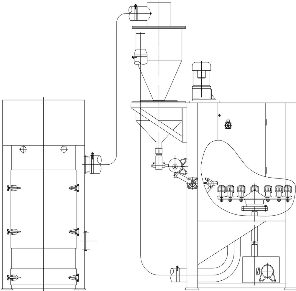
3) 经喷砂后的零件表面硬化，能提高零件的耐磨性和疲劳强度。
